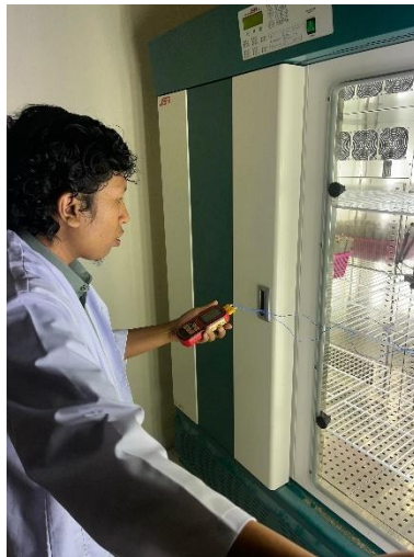
Gambar 9. Pengujian Kesesuaian Suhu Germinator
